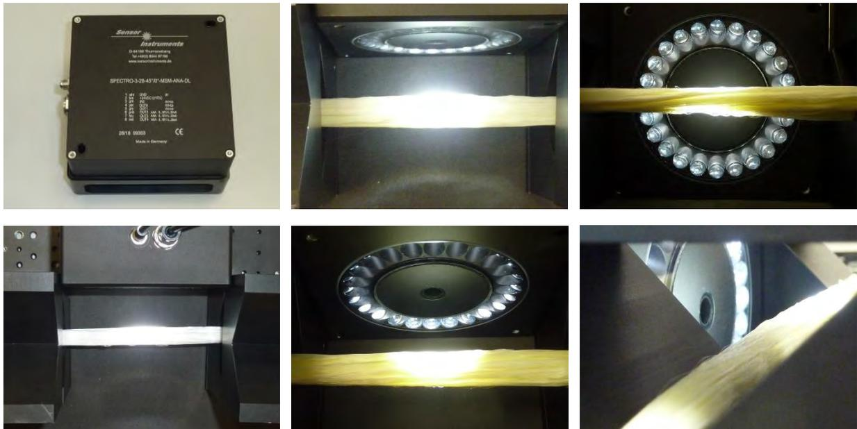
Le faisceau de fibres dispose d'un diamètre de typiquement 15 mm et la distance par rapport aux capteurs est d'environ 28 mm
